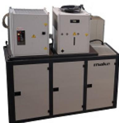
Il rapporto di coppia viene assicurato da un sistema efficace di trasmissione di potenza al mandrino tramite un motore SIEMENS raffreddato ad acqua, un cambio meccanico e una scatola di trasmissione ad ingranaggi; pertanto abbiamo un **doppio frigorifero** uno per il raffreddamento dell'acqua e l'altro per il raffreddamento dell'olio.
