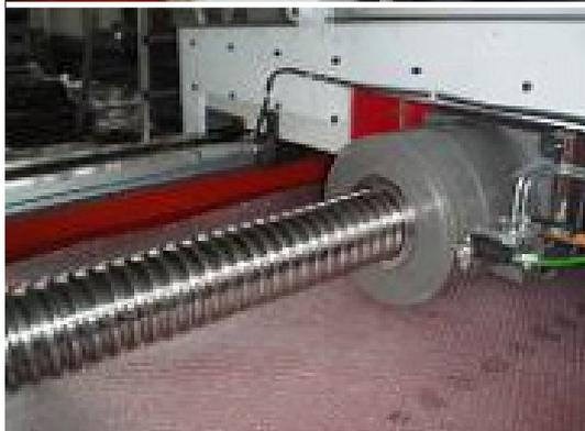
Asse X: chiocciola mobile con vite diam. 80 mm mentre l'asse verticale è comandato da 2 motoriduttori con doppia vite e doppia riga ottica.
